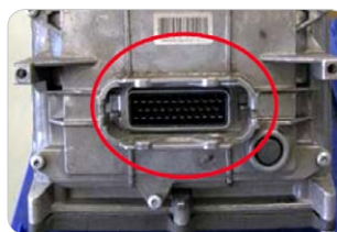
Chybějící záslepky na elektrické zásuvce
