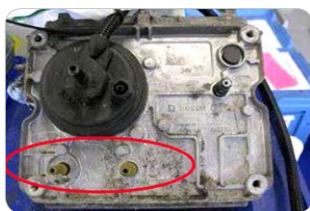
Chybějící záslepky na vývodech
