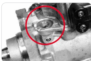
Poškozené závity na tělese čerpadla
