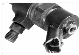
Poškozený konektor vstřikovače
