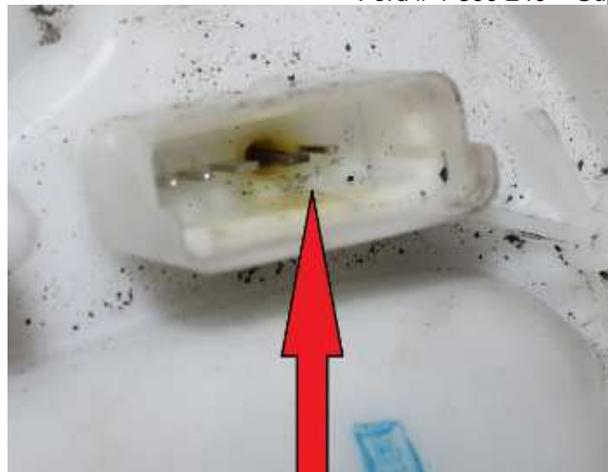
Zur Behebung der Beanstandung, eine neue Kraftstoffpumpen-Gebereinheit mit Kabelstrang und überarbeitetem Stecker einbauen, sowie Schaumstoffauflagen auf der Oberfläche des Kraftstofftanks anbringen.
